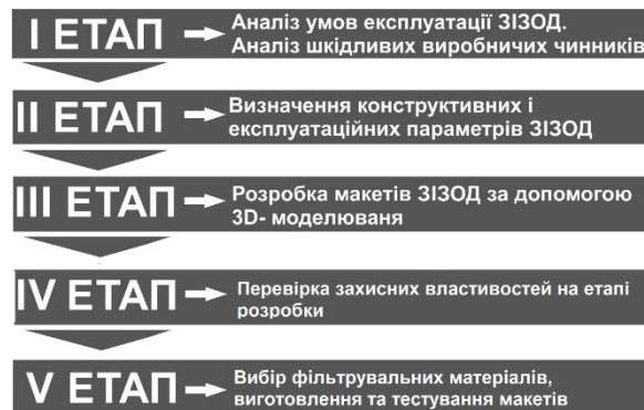
Рис. 2. Етапи проектування фільтрувальних респіраторів
