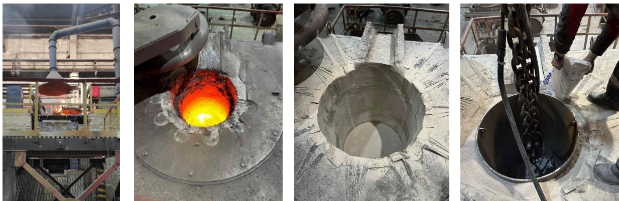
Рис. 2. Робота та футерування трьохтонної індукційної печі (виробництва EGES, Туреччина): а – загальний вигляд печі; б – робочий простір печі після випуску металу; в – процес футерування днища печі; г – завантаження машини для футерівки печі в піч краном
