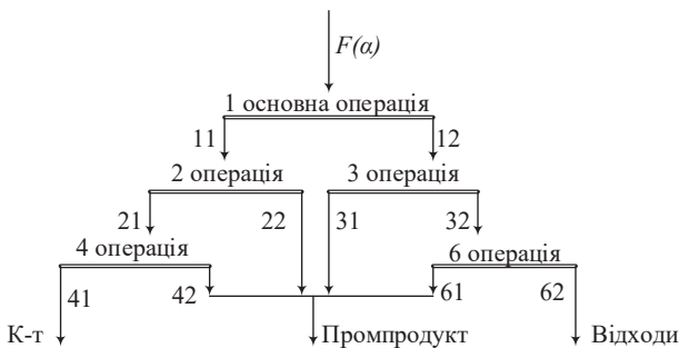
Рис. 5. Технологічний блок з'єднання сепараторів з узгодженими характеристиками за розділення на три продукти
