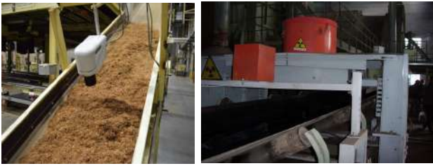
а) б) Рис. 1. Приклади застосування на виробництві аналізаторів вологості: а – оптичний (ІЧ), б – нейтронний
