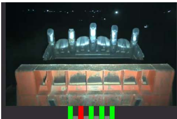
Рис. 5. Моментальне відображення відсутніх зубів ковша
