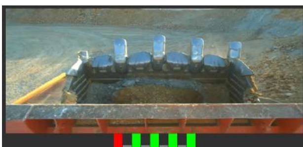
Рис. 4. Моментальне відображення відсутніх зубів ковша
