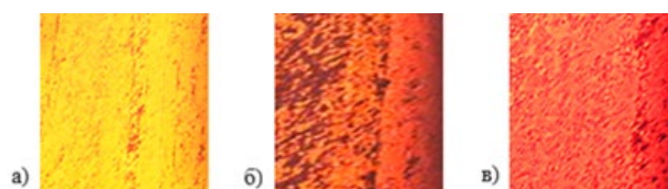
Рис. 4. Сляби з різним ступенем забруднення загальної площі слябу: а) до 15%, б) до 70%, в) до 100%
