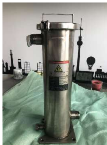
Рис. 6. Зовнішній вигляд прохідного магнітного фільтра
