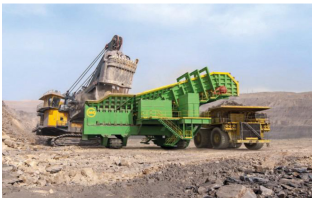
Рис. 3. Екскаваторно-автомобільний комплекс, обладнаний спеціальним бункером-перевантажувачем
