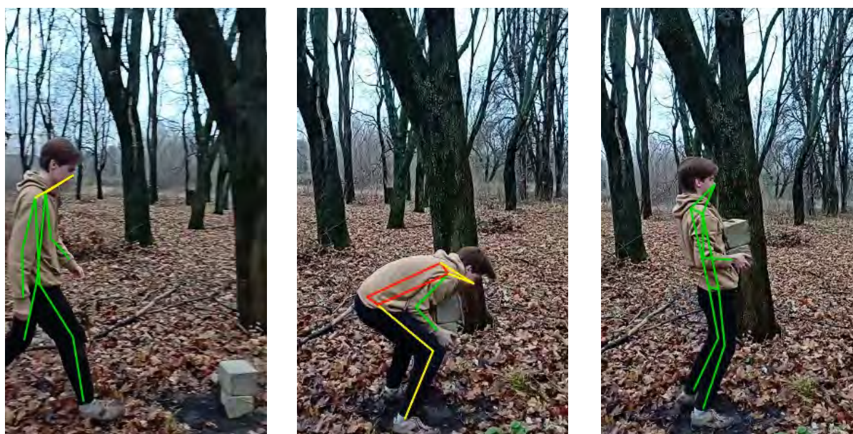
Рис. 2. Ергономічна оцінка найбільш уразливих зон тіла учня під час ручного підйому та перенесення бетонного блоку: а – у розігнутому стані; б – у зігнутому стані; в – під час перенесення бетонного блоку
