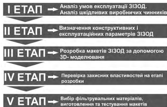
Рис. 2. Етапи проектування фільтрувальних респіраторів
