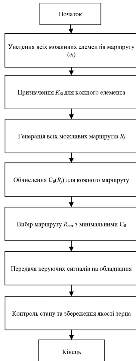
Рис. 3. Схема алгоритму вибору маршруту транспортування зерна за критерієм мінімального бою
