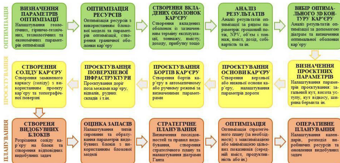
Рис. 5. Алгоритм процесу проектування та планування відкритих гірничих робіт за допомогою Micromine Beyond
