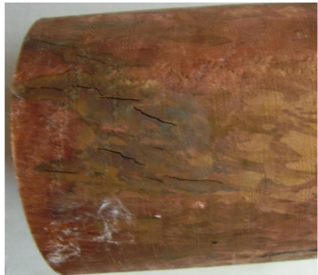
Рис. 3. Поздовжні міжкристалічні тріщини на поверхні експериментальної трубної заготовки
