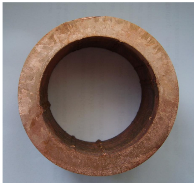
Рис. 2. Макроструктура поперечного перерізу дослідної мідної заготовки, що відлита на установці безперервного горизонтального лиття
