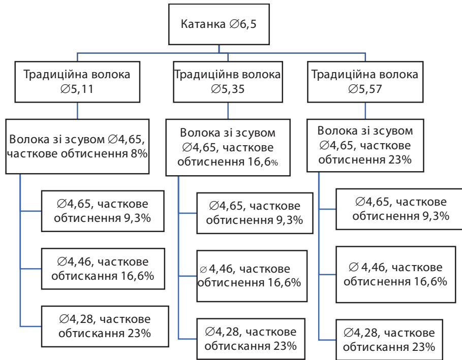
Рис. 1. Схема волочіння, у процентах наведено часткове обтиснення
