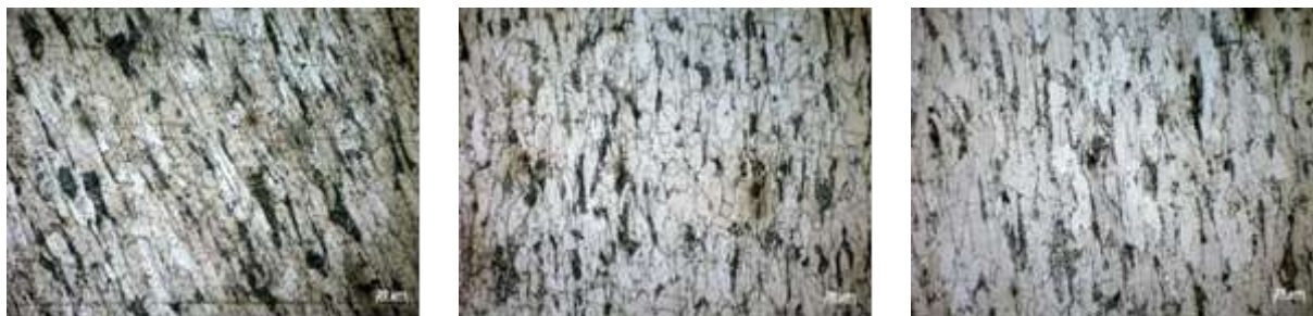
Рис. 5. Оптична мікроскопія дроту після обтискання зсувною волокою зі збільшенням ступеня деформації звичайним волочинням (подовжній перетин, центр, збільшення x 500)
