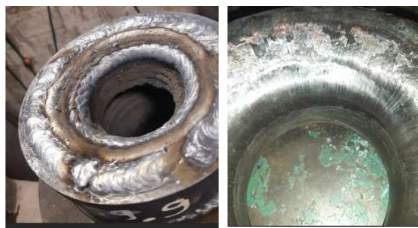
а б Рис. 5. Загальний вигляд сфероконічної матриці зі сталі 3Х3М3Ф діаметром 59,9 мм для пресування, наплавленої сталлю 45Х5В2ГСМФА каскадно-кільцевим способом (а) та після 90 пресувань сплаву МНЖ 5-1 (б)
