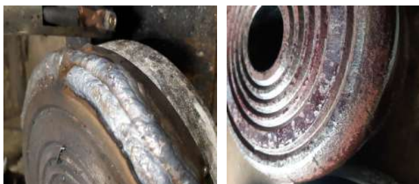
а б Рис. 6. Загальний вигляд пресової шайби діаметром 205 мм: а) після наплавлення; б) після 40 циклів пресувань сплаву МНЖ 5-1
