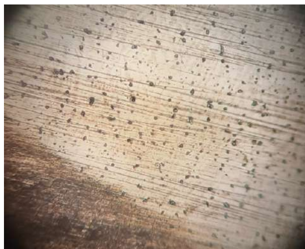
Рис. 7. Мікроструктура наплавленого металу типу 45Х5В2ГСМФА (x400)
