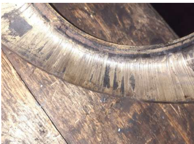
Рис. 2. Налипання матеріалу заготовки на матрицю зі сталі 3ХЗМЗФ
