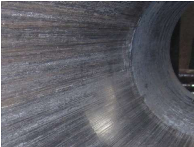
Рис. 1. Мікрорізання заготовкою робочої поверхні прес-втулки зі сталі 38ХНЗМФА внаслідок її неналежної твердості
