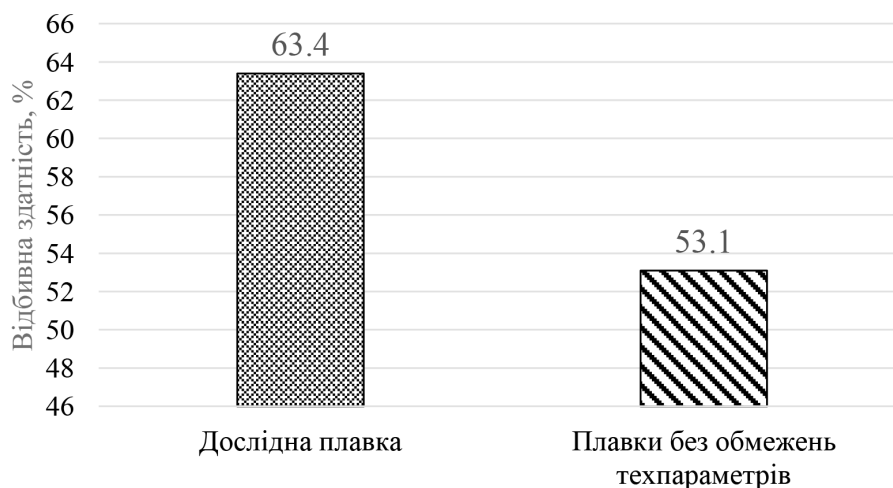
Рис. 7. Середні значення відбивної здатності дослідної плавки та плавки у потоці
