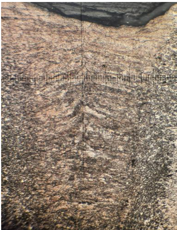
Рис. 6. Загальний вигляд мікроструктури зварного шва ( \times 400 ) після травлення 4 % розчином \text{HNO}_3 в етанолі
