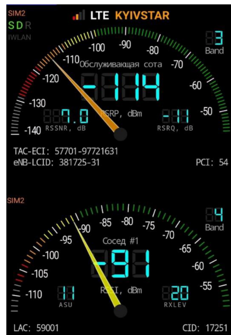
Рис. 9. Сигнал від базової станції 4G і сусідньої 2G
