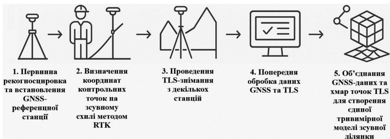
Рис. 1. Схема етапів інтегрованої методики 3D-моделювання зсувів на основі GNSS і TLS
