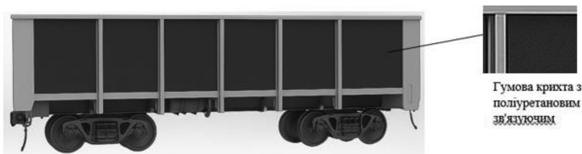
Рис. 3. Бічні стінки напіввагону, покриті гумовою крихтою з поліуретановим зв'язуючим
